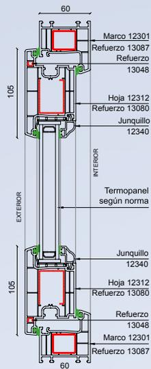
ACRISTALAMIENTO DESDE 4mm HASTA 36mm DE ESPESOR. DISEÑO DE 4 CÁMARAS DE AISLACIÓN EN MARCO.
